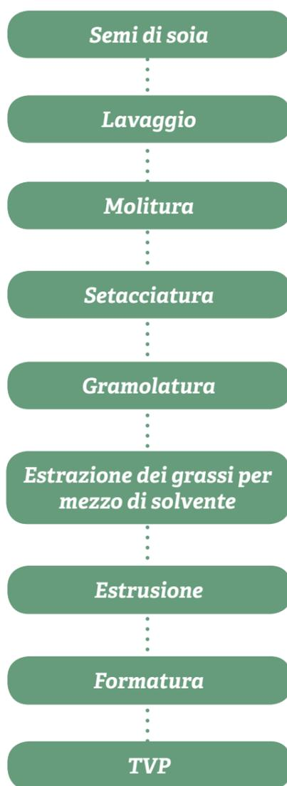
Fig. 1 - Processo produttivo TVP a base di soia [4]
